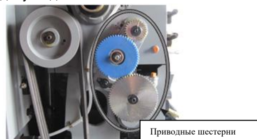
Рис. 83. Расположение приводных шестерен, которым требуется смазка.
