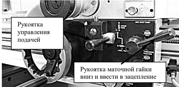
Рис. 54. Установка элементов управления кареткой для нарезания резьбы
