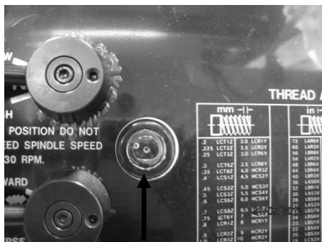
Рис.23. Смотровое окно масляного насоса.
