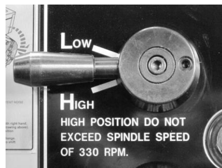
Рис. 24. Рукоятка переключения диапазонов коробки скоростей
