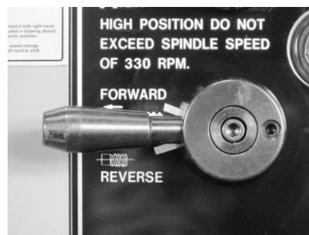
Рис. 18. Рукоятка выбора направления подачи Вперед (Forward)/Назад (Reverse)
