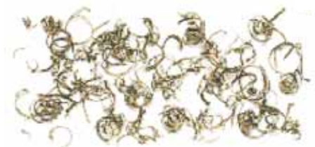
Очень мелкая, пылевидная стружка - подача должна быть увеличена
